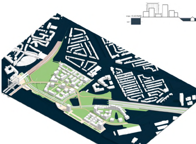
Figuur 11.8 Overstroomd gebied (zwart) bij waterpeil NAP +3,45 m en dijkdoorbraak (huidige situatie, kans T1000-T3000) alternatief groen en gezond (bron: Mecanoo, 6 juni 2023)
