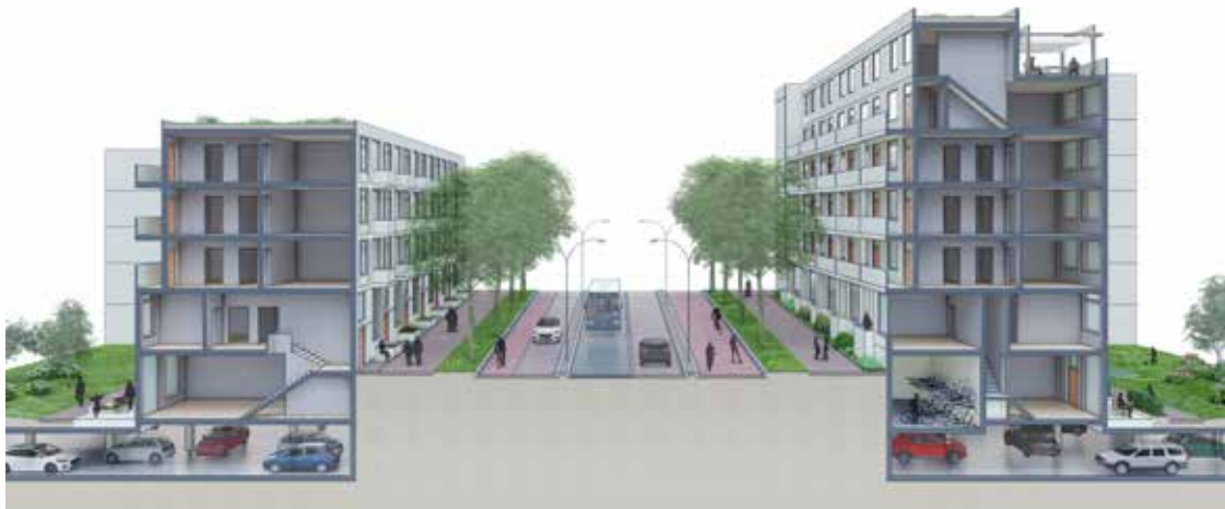
afb. 2.4C - Doorsnede over hoge deel van Stadsstraat
