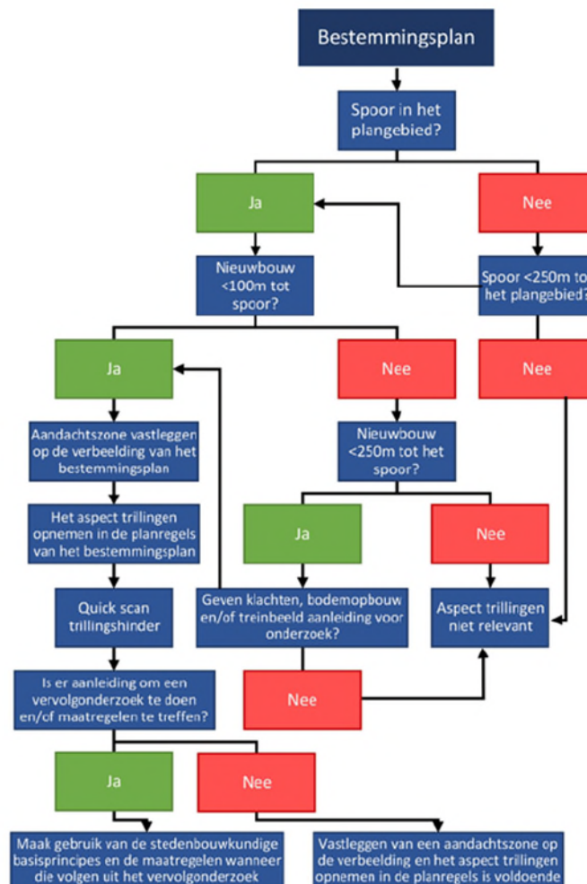
Afbeelding 2: stroomschema Handreiking Nieuwbouw en Spoortrillingen
