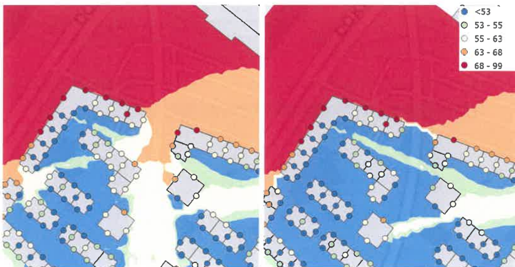
Figuur 16.41 Effect van afscherming tussen gebouwen in M3 voor spoorweglawaaï. Links zonder afscherming, rechts met afscherming
