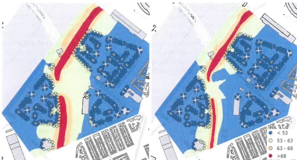
Figuur 16.35 Geluidcontour van de Laan der VN zonder (links) en met stil asfalt (rechts)
