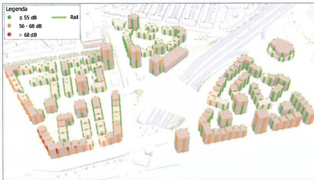
Figuur 16.31 Spoorweglawaai in Maasterras vanaf de westzijde
