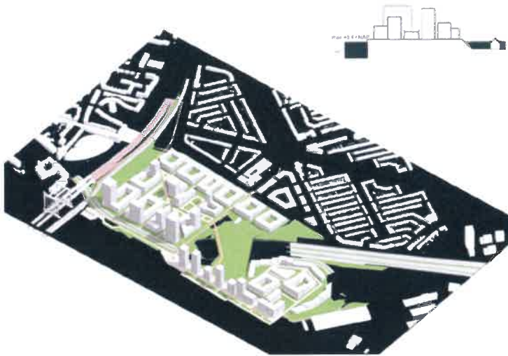
Figuur 11.6 Overstroomd gebied (zwart) bij waterpeil NAP +3,45 m en dijkdoorbraak (huidige situatie, kans T1000-T3000) alternatief Hoogstedelijk (bron: Mecanoo, 6 juni 2023)
