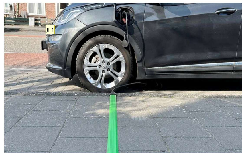
Figuur 6. Voorbeeld van toepassing van een platte kabel (Foto FlatPower)
