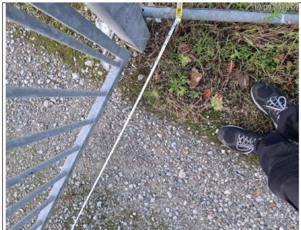
De breedte van de poort opgemeten = 5,30 meter
