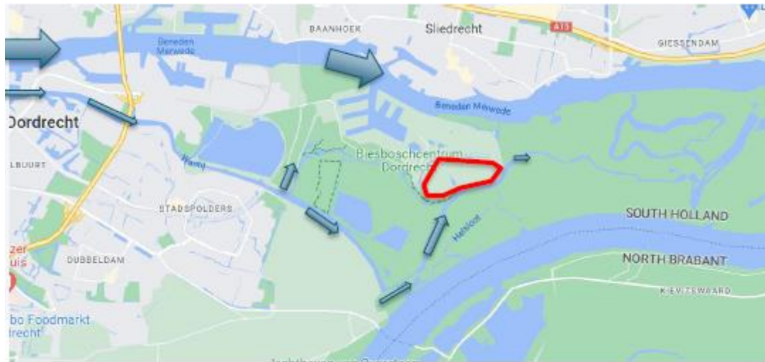
Figuur 4 De pijlen tonen de getijdestromen tijdens vloed rondom de Hel- en Zuilespolder (rood omlijnd) in de huidige situatie. De grootte van de pijlen geven een indicatie van de grote van de getijstroom. [Bron: Witteveen en Bos, 2023]
