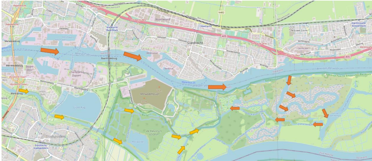
Figuur 6 Getijdenstromen huidige situatie - Geel via Wantij, oranje via het Gat van den Hengst
