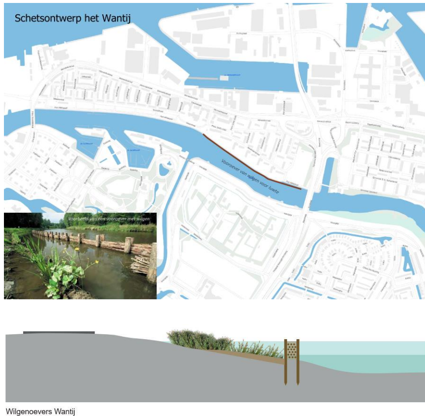
Afbeelding 2.5 Vooroever Wantij: locatie, voorbeeld en principetekening
