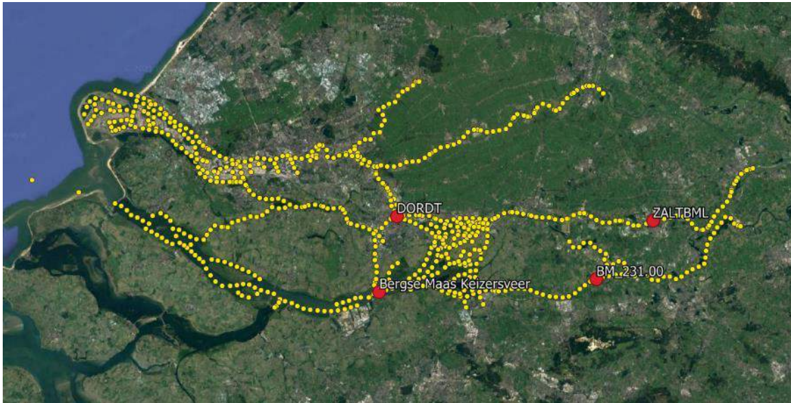
Afbeelding 4.2 Uitvoerlocaties SOBEK-model rmm-j15_5-v1 (geel) en uitvoerlocaties nabij de randen van het WAQUA-model die gebruikt zijn voor het afleiden van randvoorwaarden (rood)
